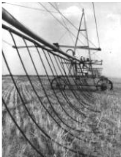
Рис.4. Застосування переобладнаної широкозахватної машини "Фрегат" для поливу способом заповнення попередньо нарізаних клиноподібних щілин на зрошувальному полі
