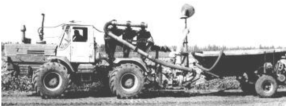
Рис.2. Мобільна установка під час приготування і внесення із дощувальною водою дезактивууючого розчину для нейтралізації небезпечної речовини.
