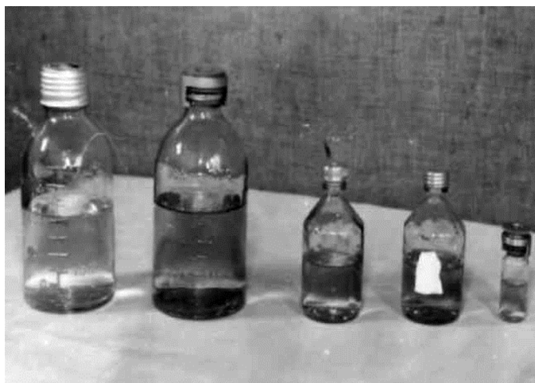
Рис. 2 Загальний вигляд флаконів з середовищем закритих гумовими пробками та металевими ковпачками з отвором посередині
