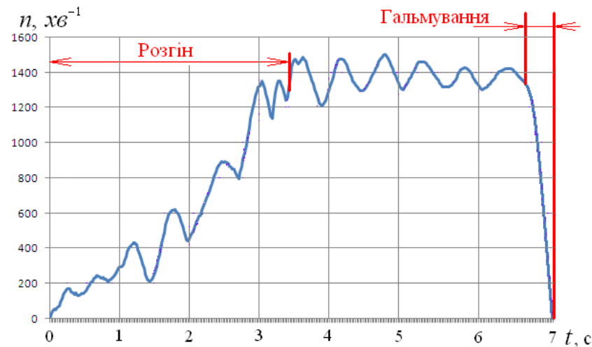
Рис. 5. Графік зміни частоти обертання ротора електродвигуна
