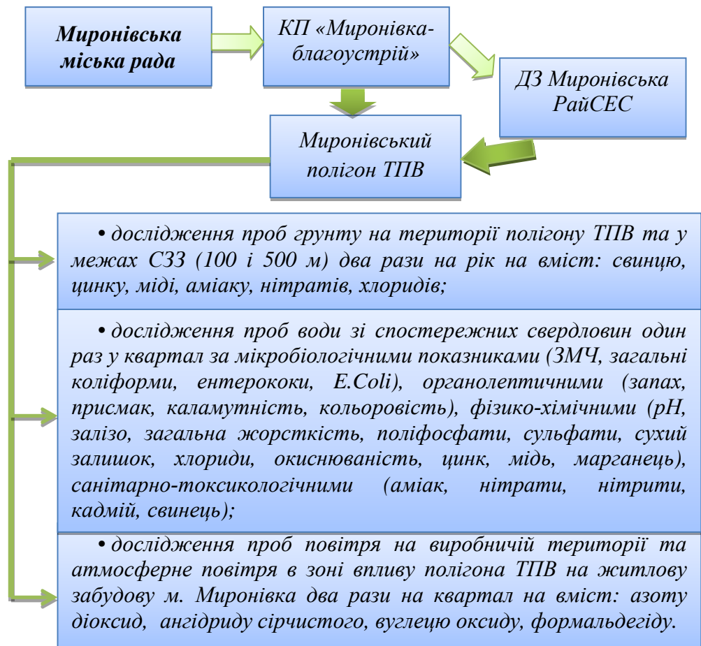
Рис. 1. Схема чинної системи спостережень за станом природного середовища у межах Миронівського полігону ТПВ [7]
